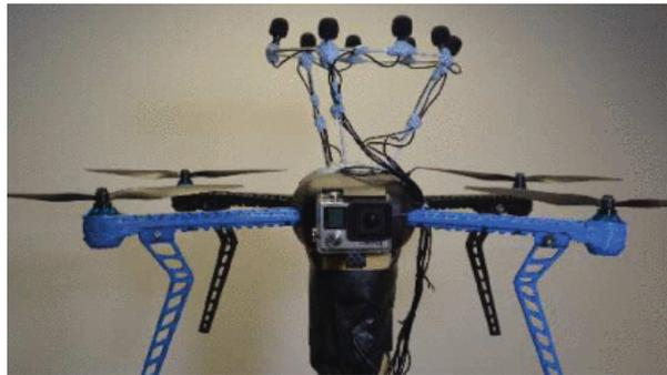
FIGURE 2.1 Emplacement des microphones sur le drone de Wang et Cavallaro [49]
