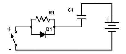
Fig. 2.26 RCD Snubber
