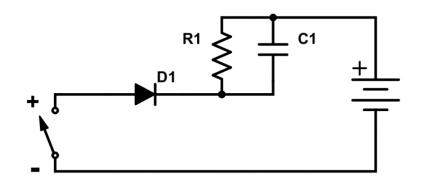
Fig. 2.28 RCD Snubber
