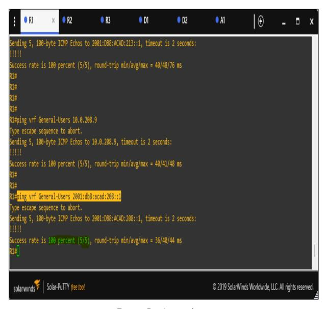
Una vez configurada toda la red lo siguiente será realizar pings desde R1 hacia R3 para comprobar el estado de la red. Para ello realizamos ping a **vrf General-Users 2001:db8:acad:208::1** y se logra evidenciar que hay comunicación al 100% entre R1 a R3.
