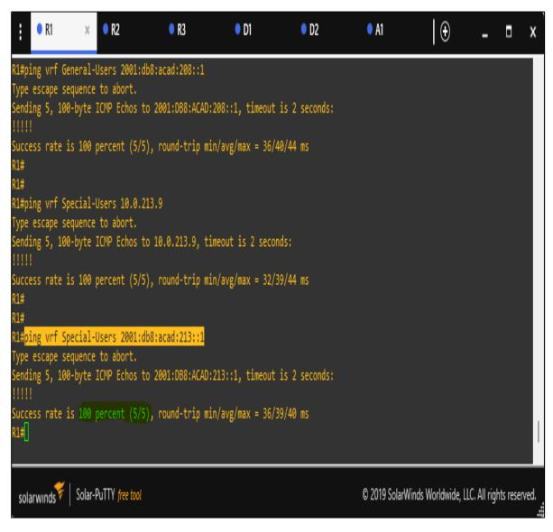
Una vez configurada toda la red lo siguiente será realizar pings desde R1 hacia R3 para comprobar el estado de la red. Para ello realizamos ping a **vrf Special-Users 2001:db8:acad:213::1** y se logra evidenciar que hay comunicación al 100% entre R1 a R3.
