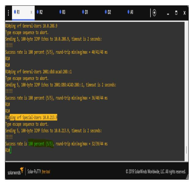
Una vez configurada toda la red lo siguiente será realizar pings desde R1 hacia R3 para comprobar el estado de la red. Para ello realizamos ping a **vrf Special-Users 10.0.213.9** y se logra evidenciar que hay comunicación al 100% entre R1 a R3.
