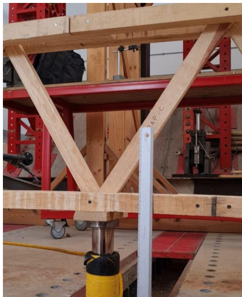
Figura 24. Configuración de lectura de desplazamiento. Imagen propiedad del autor.
