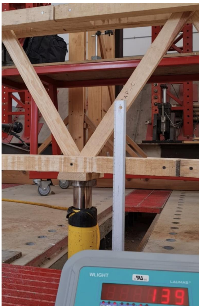
Figura 18. Carga crítica al momento de la falla. Imagen propiedad del autor.
