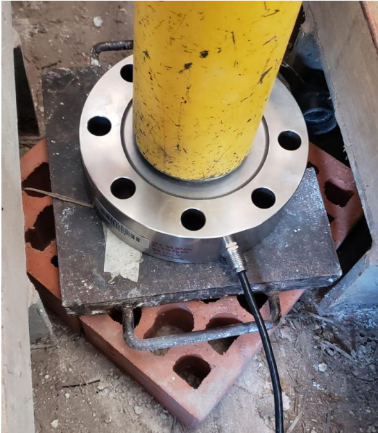
Figura 17. Configuración en la base del gato para aplicar la carga. Imagen propiedad del autor.
