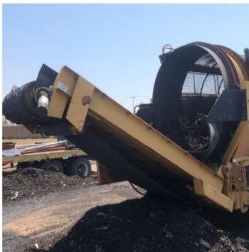
*Figura 2. Mecanismo de cribado*
