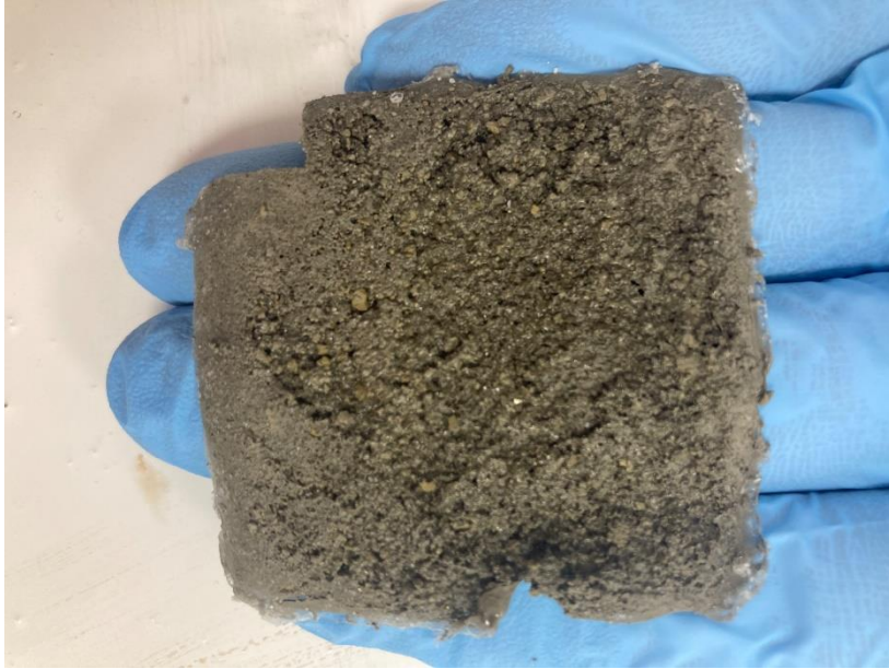
Figura A6. Compósito con 1 g de nanopartículas de plata y 1.5 ml de tolueno (inferior).
