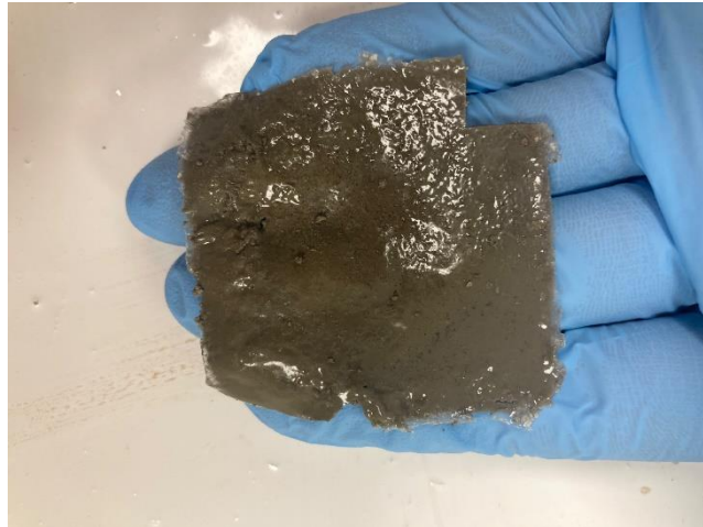
Figura A5. Compósito con 1 g de nanopartículas de plata y 1.5 ml de tolueno (superior).
