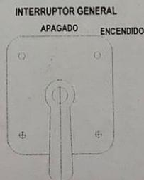
7. Accione el interruptor 2 polos un tiro del variador de velocidad a la posición "Encender", se encenderá el foco verde.
