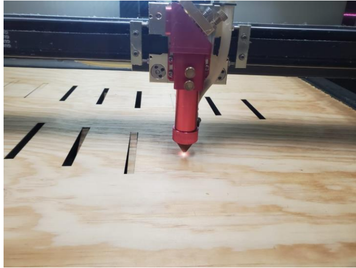
Figura.7.1: Corte láser (laboratorio del edificio H, ITESO)
