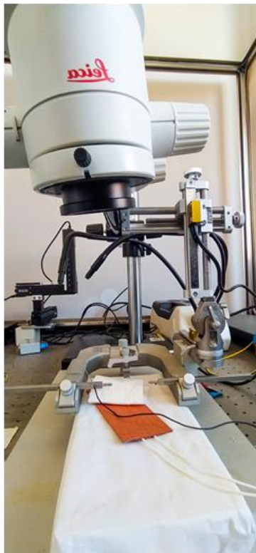
Figura 20: Equipamiento para la realización de los experimentos in vivo . A) Disposición del set up de trabajo, sobre una mesa antivibratoria se dispone la lupa, el estereotáxico y el instrumental de cirugía. B) Zona de fijación del ratón y manta térmica. C) Instrumental utilizado para la obtención de los registros.
