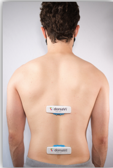
Figura 1. Colocación de los IMUs (Dosarvi ViMove™).
