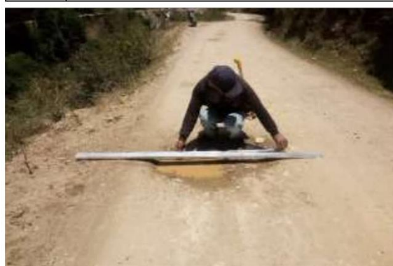
Fotog. Progresiva : 30+769,00 - 31+000,00 107 Se observa la medición del " BACHRES " en el punto más crítico.
