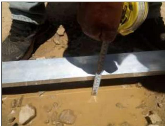
Fotog. Progresiva : 31+000,00 - 31+053,00 111 Se observa que el " BACHRES " Tiene: 7,00 cm Considerado como: NG: 2
