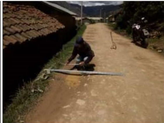
Fotog. Progresiva : 27+500,00 - 27+843,00 74 Se observa la medición del " BACHRES " en el punto más crítico.
