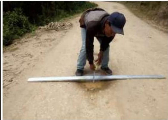
Fotog. Progresiva : 31+500,00 - 31+780,00 122 Se observa la medición del " BACHRES " en el punto más crítico.
