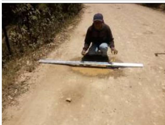
Fotog. Progresiva : 29+500,00 - 30+000,00 95 Se observa la medición del " BACHRES " en el punto más crítico.
