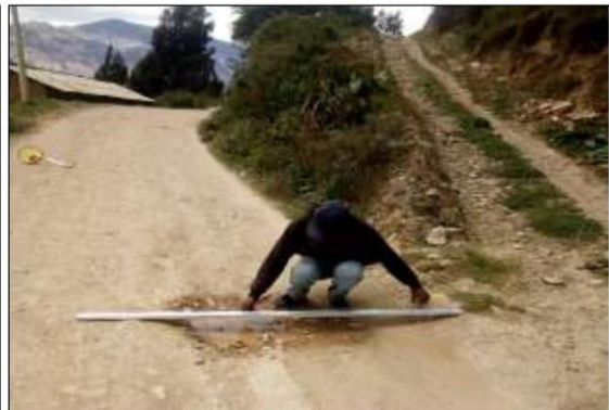
Fotog. Progresiva : 32+000,00 - 32+221,00 128 Se observa la medición del " BACHRES " en el punto más crítico.
