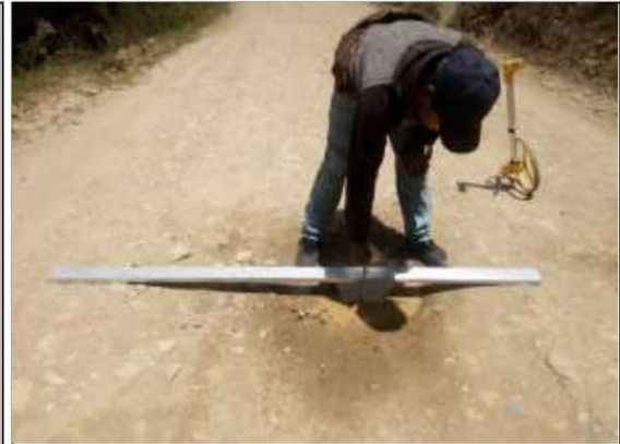
Fotog. Progresiva : 30+000,00 - 30+500,00 98 Se observa la medición del " BACHRES " en el punto más crítico.
