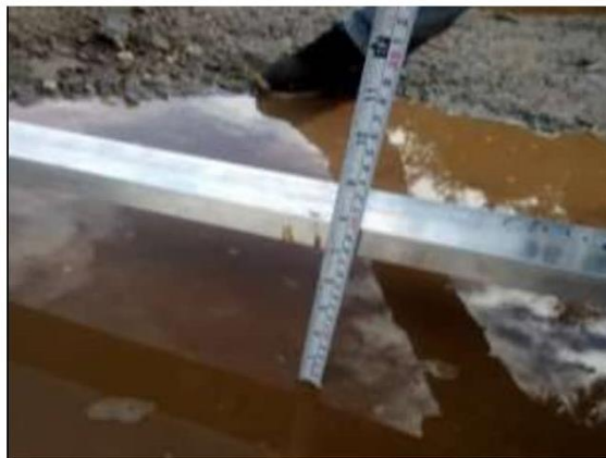
Fotog. 9 Progresiva : 24+166,00 - 24+220,00 Se observa que el " BACHES " Tiene: 0,00 cm Considerado como: NG: 1,2,3
