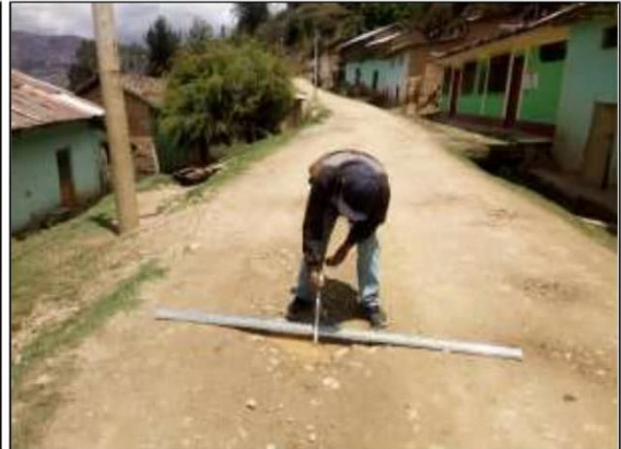
Fotog. Progresiva : 28+000,00 - 28+076,00 80 Se observa la medición del " BACHRES " en el punto más crítico.
