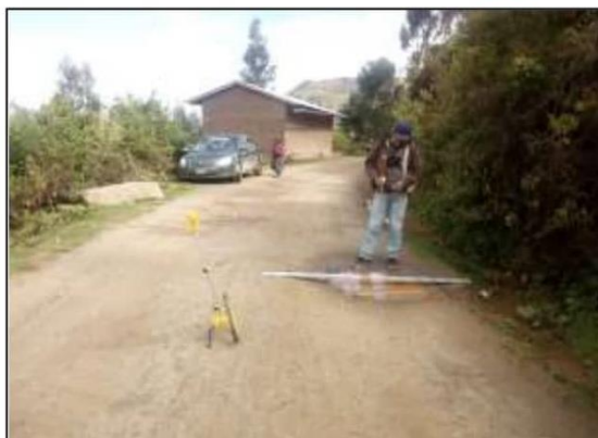
Fotog. Progresiva : 24+046,00 - 24+133,00 2 Se observa la medición del " BACHES " en el punto más crítico.
