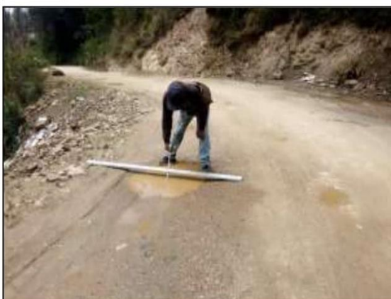
Fotog. Progresiva : 31+145,00 - 31+265,00 113 Se observa la medición del " BACHRES " en el punto más crítico.
