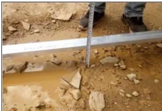
Fotog. Progresiva : 32+000,00 - 32+221,00 129 Se observa que el " BACHRES " Tiene: 10,00 cm Considerado como: NG: 2
