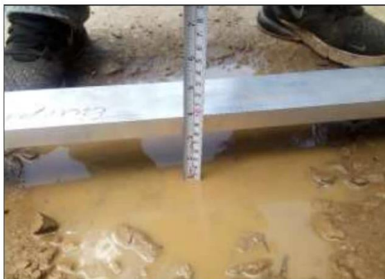
Fotog. Progresiva : 31+500,00 - 31+780,00 123 Se observa que el " BACHRES " Tiene: 7,00 cm Considerado como: NG: 2
