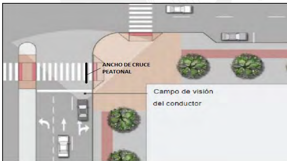
Figura 32: Ancho de cruce peatonal
