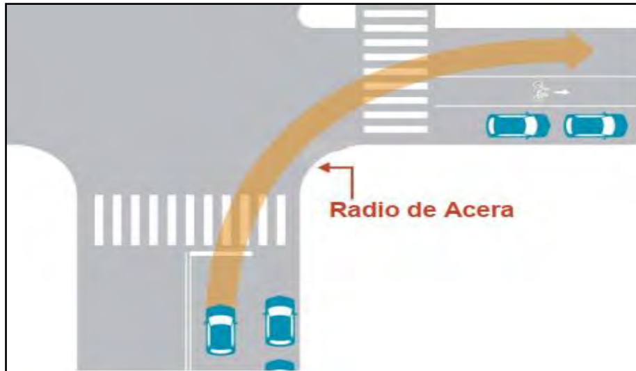
Figura 40: Esquinas de aceras en modelo actual
