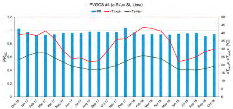
Fig. 1-11: Resultados de sistema fotovoltaico de silicio amorfo en Lima. Modificado de: [18]
