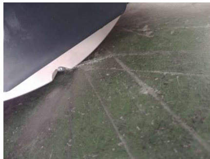
ILUSTRACIÓN 33 – RUEDA QUE HA ROZADO CON LA PARTE EXTERIOR EL SUELO (FOTO TOMADA DE LA PRUEBA REAL).
