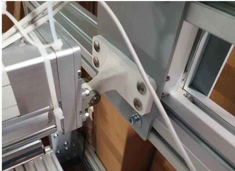
Figura 16: Unión de la zona trasera del actuador [Fuente propia]
