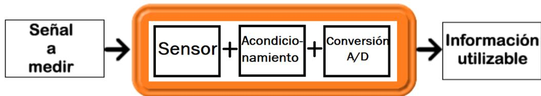
Figura 33: Etapas del sistema de la adquisición de datos [Fuente propia]
