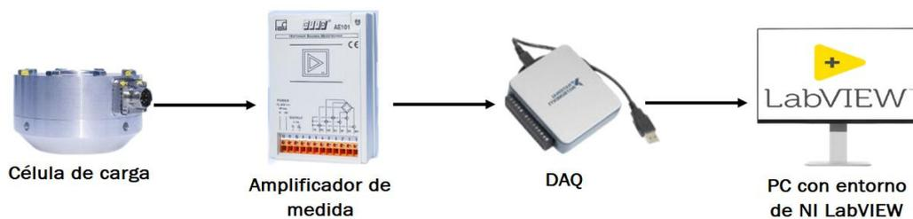
Figura 34: Componentes de la cadena de medida para la adquisición de datos [Fuente propia]
