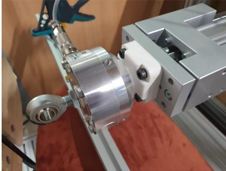
Figura 20: Montaje entre la zona delantera del actuador y la trasera de la célula [Fuente propia]
