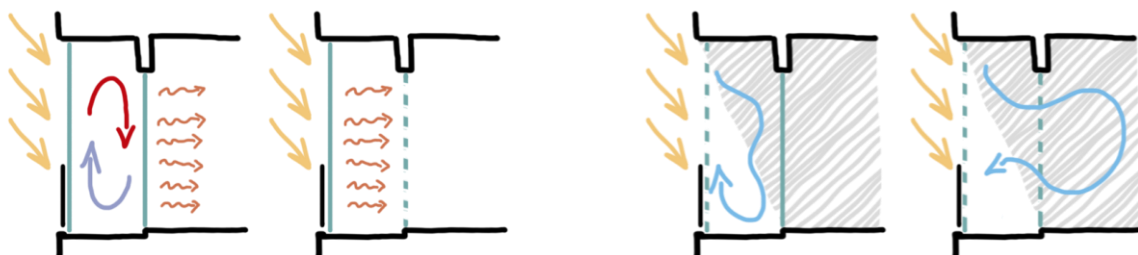
Esquema climático galería sur en invierno
