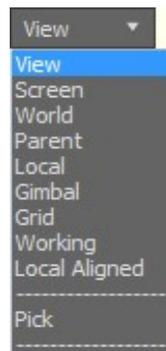
La opción View posiciona el eje X de izquierda a derecha y el eje Y de arriba abajo en todas las vistas ortográficas. El eje Z siempre es ortogonal a éstos:
