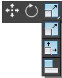
Para realizar la transformación, se hace clic en el botón, se selecciona el objeto y se arrastra para introducir la nueva posición, ángulo de rotación y/o escala. Es importante tener en cuenta el “Gizmo”, que es un icono muestra los ejes, y que aparece al seleccionar un objeto con un botón de transformación. Las operaciones pueden realizarse seleccionando cada eje o cada par de ejes (planos) o los tres ejes (transformación libre).
