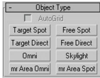
Las luces target **spotlight** simulan un cañon de luz con flaps. Para crearlas hay que decir hacia dónde apuntan arrastrando una vez creada la fuente. Podemos convertir de tipo Target a Free y el efecto es que el punto hacia el que apunta permanece inalterado con respecto a la posición del foco cuando lo movemos.
