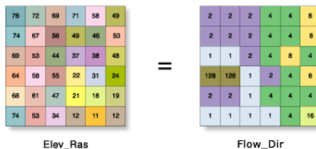
Figura 7 Valores de elevación convertidos en códigos de dirección de flujo Fuente: ArcGIS Help [4]
