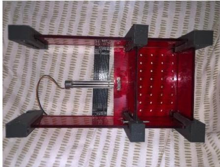
Imagen 46 Caja estructural acrílica de la máquina separadora de residuos
