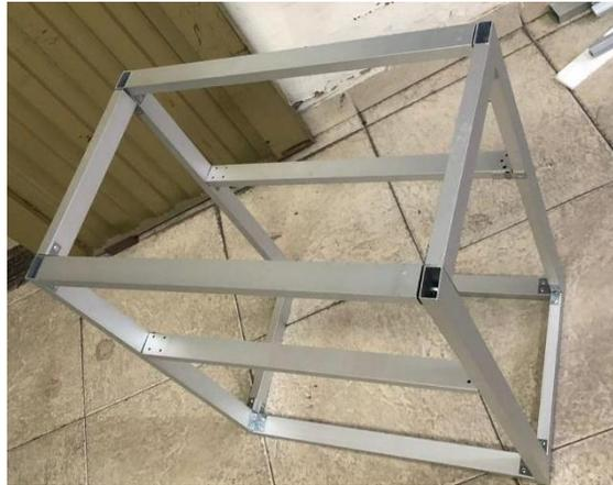
Imagen 44 Cuerpo estructural caneca separadora en aluminio
