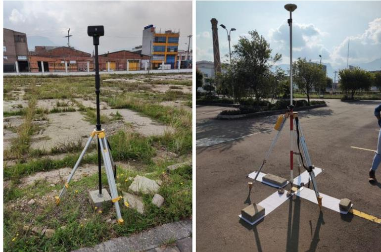
Imagen 4. GNSS GPS DJI D-RTK2 – Trimble 5700 - Fuente propia - 2022
