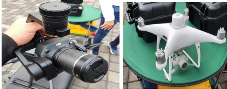
Imagen 2. Sensores Digitales DJI P1 – CMOS 1” Fuente propia - 2022
