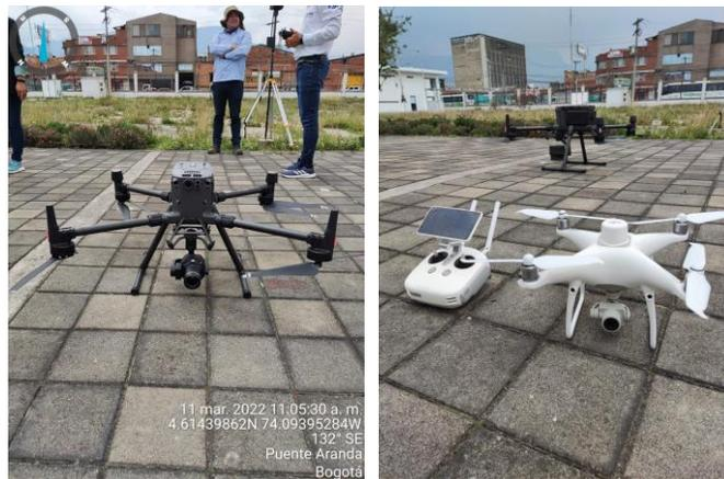
Imagen1 . RPAS Multirrotor DJI M300 RTK – PH4RTK – Fuente propia - 2022
