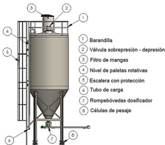
Figura 5. Partes de un Silo
