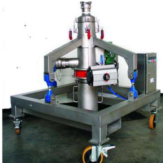
Figura 6. Tamiz con una capacidad máxima de 30.000 kg/h
