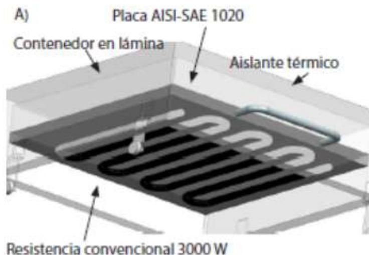
**Figura 6.** Sistema de calentamiento [15]
