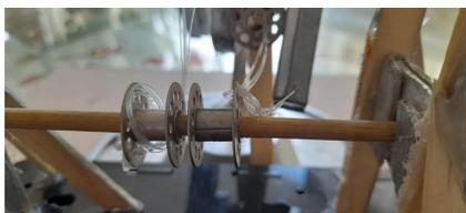
**Figura 9.** Bobinas de hilo para el movimiento de los dedos
