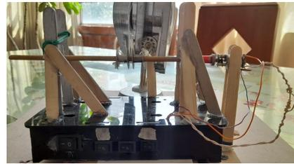
**Figura 10.** Base para ejecutar el movimiento de los dedos del brazo
