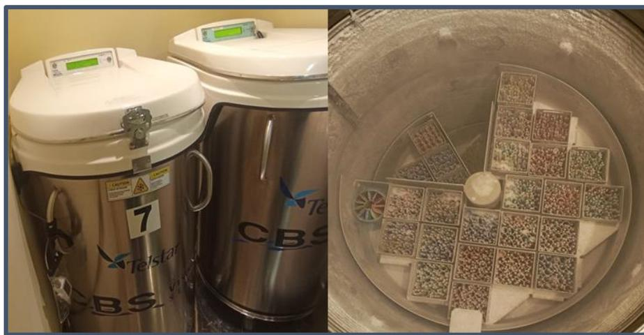
**Figura 17:** Bancos criogénicos CBS en fase vapor de nitrógeno, parte externa (izquierda) e interna (derecha)
