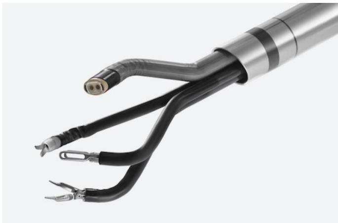
Fig. 18: Endoscopio flexible da Vinci SP<sup>®</sup> (Intuitive Surgical).
