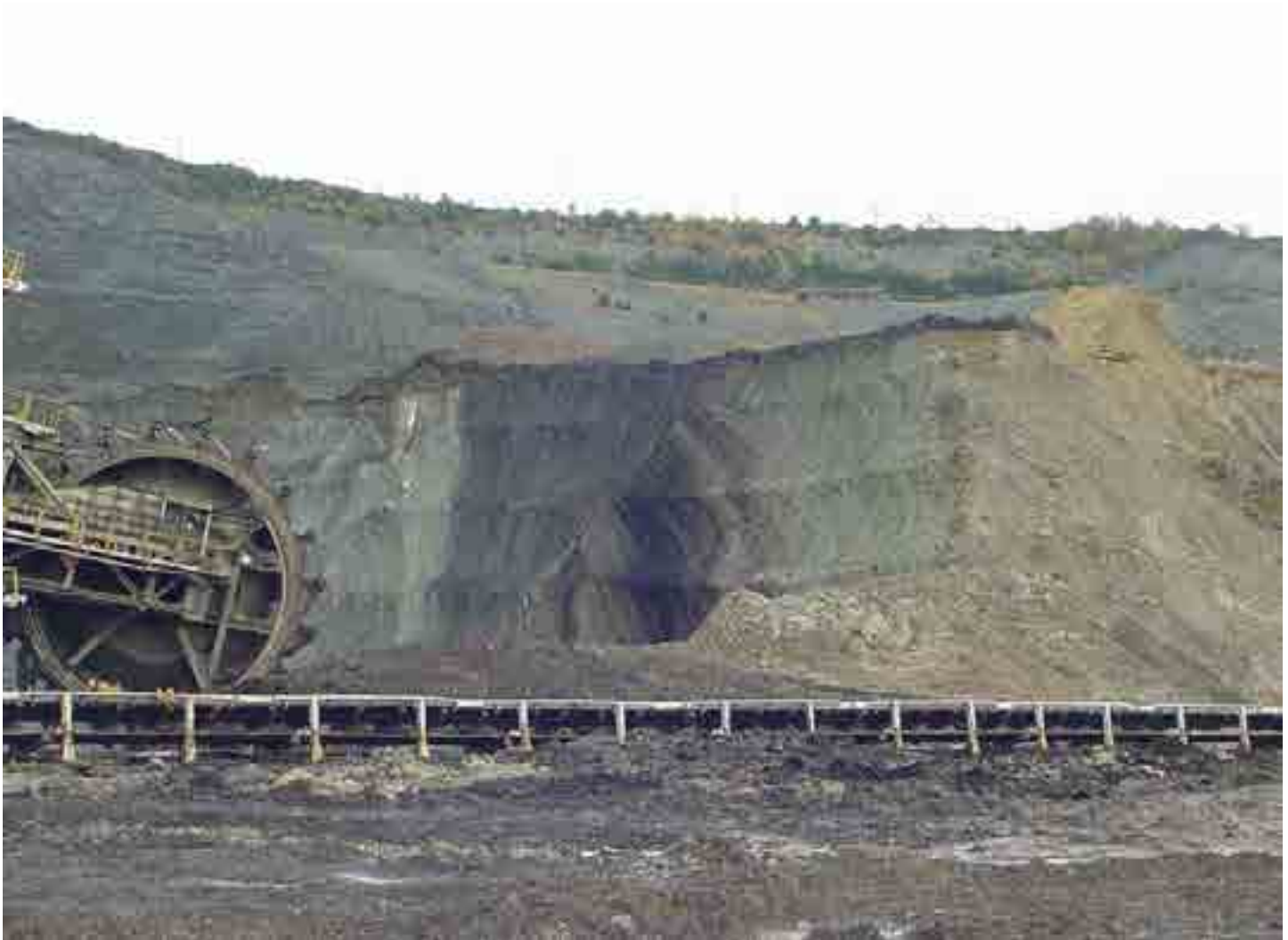
Contacto mecánico entre las flitas ordovícicas y los materiales terciarios mediante falla inversa
