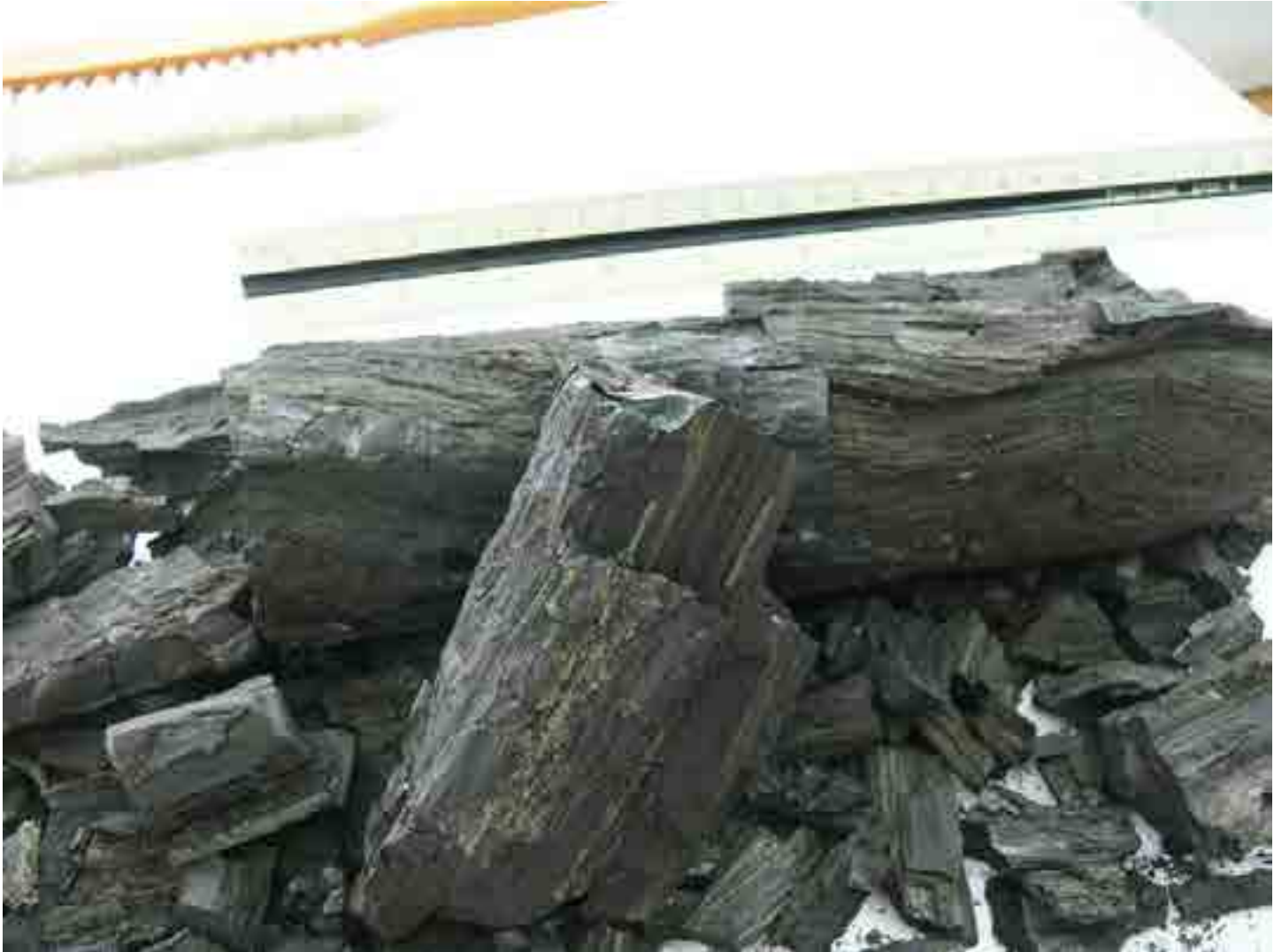
Lignito xiloide. Los tonos verdes corresponden a las acumulaciones de azufre que se producen entre las estructuras vegetales
