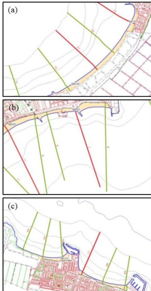
Fig. 4.2. Topología de las playas objeto de estudio: (a) abierta, (b) abierta con espigones de estabilización; (c) encajada por obras portuarias (Fuente:
