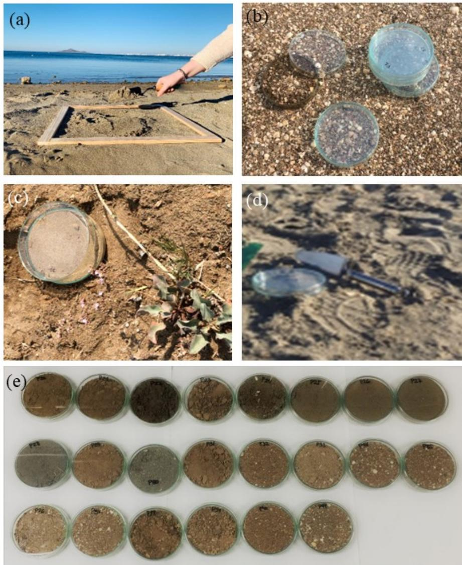
Fig. 4.5. Recolección de muestras de sedimentos costeros: (a) cuadrado de madera de 50x50 cm; (b) (c) (d) (e) muestras recogidas en placas Petri de 120 mm de diámetro.
