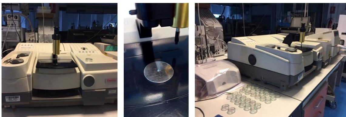
Fig. 4.12. Espectrofotómetro infrarrojo Thermo Nicolet 5700 del SIT de la Universidad Politécnica de Cartagena (UPCT).
