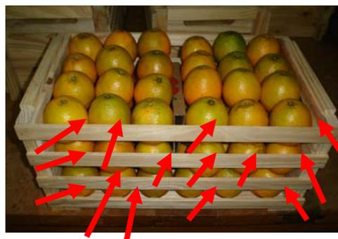
**Figura 2.** Leito de 72 laranjas dispostas em arranjo quadrado. As setas indicam as laranjas nas quais os termopares foram inseridos.
