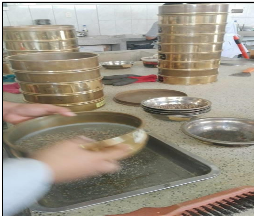
FOTOGRAFÍA 19: Ensayo de granulometría del agregado fino
