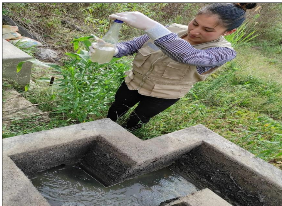
Fotografía 6.5: Toma de muestras de las aguas servidas que ingresan a la PTAR.
