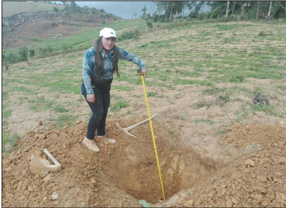
Fotografía 6.10: calicata N° 08, profundidad 1.50m.
