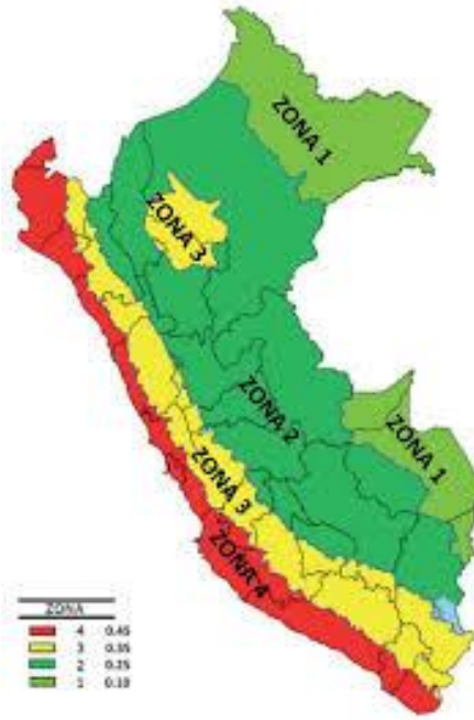
Ilustración: Zonificación del Perú, según su sismicidad.
