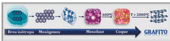
Figura 3. Esquema del proceso de carbonización/grafitización (Botas, 2013).
