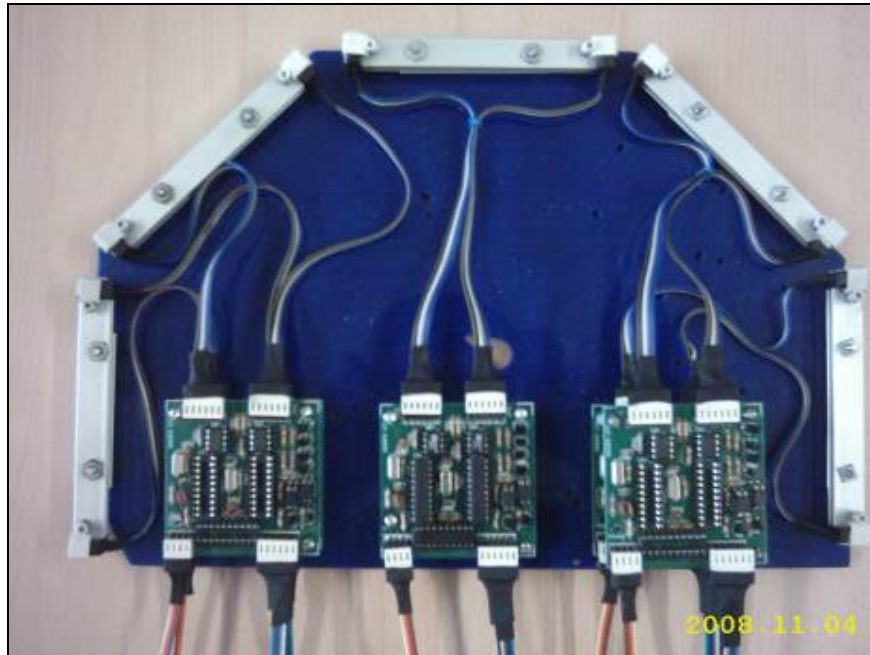
FOTO 27. Anillo de Sensores Infrarrojos
