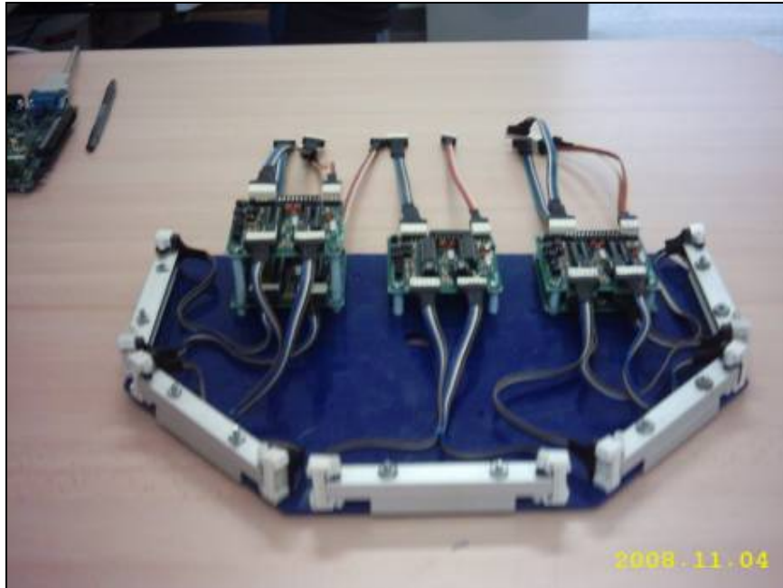
FOTO 26. . Anillo de Sensores Infrarrojos
