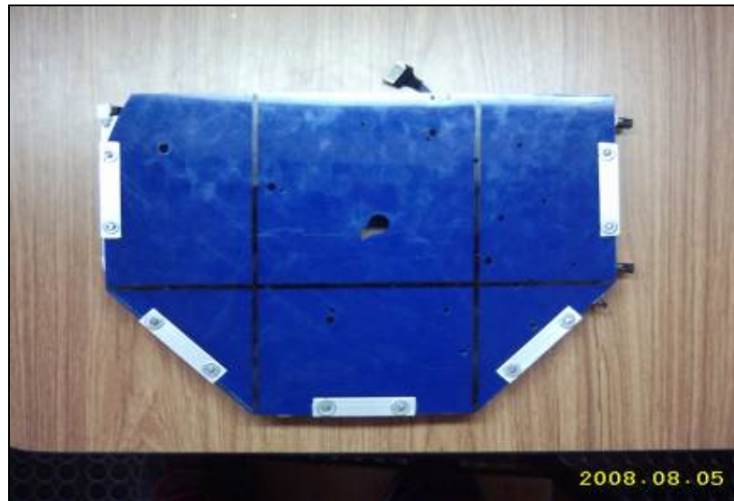
FOTO 19. Vista Superior. Estructura de soporte para sensores infrarrojos.
