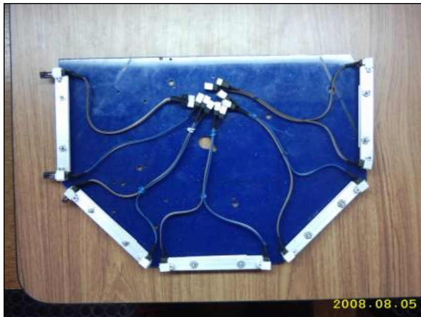
FOTO 20. Vista Inferior. Estructura de soporte para sensores infrarrojos
