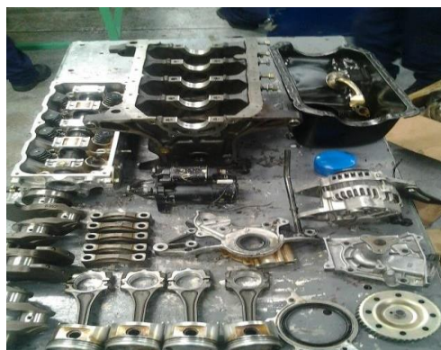
Fig.4. Ingreso motor de 4 cilindros convencional.
