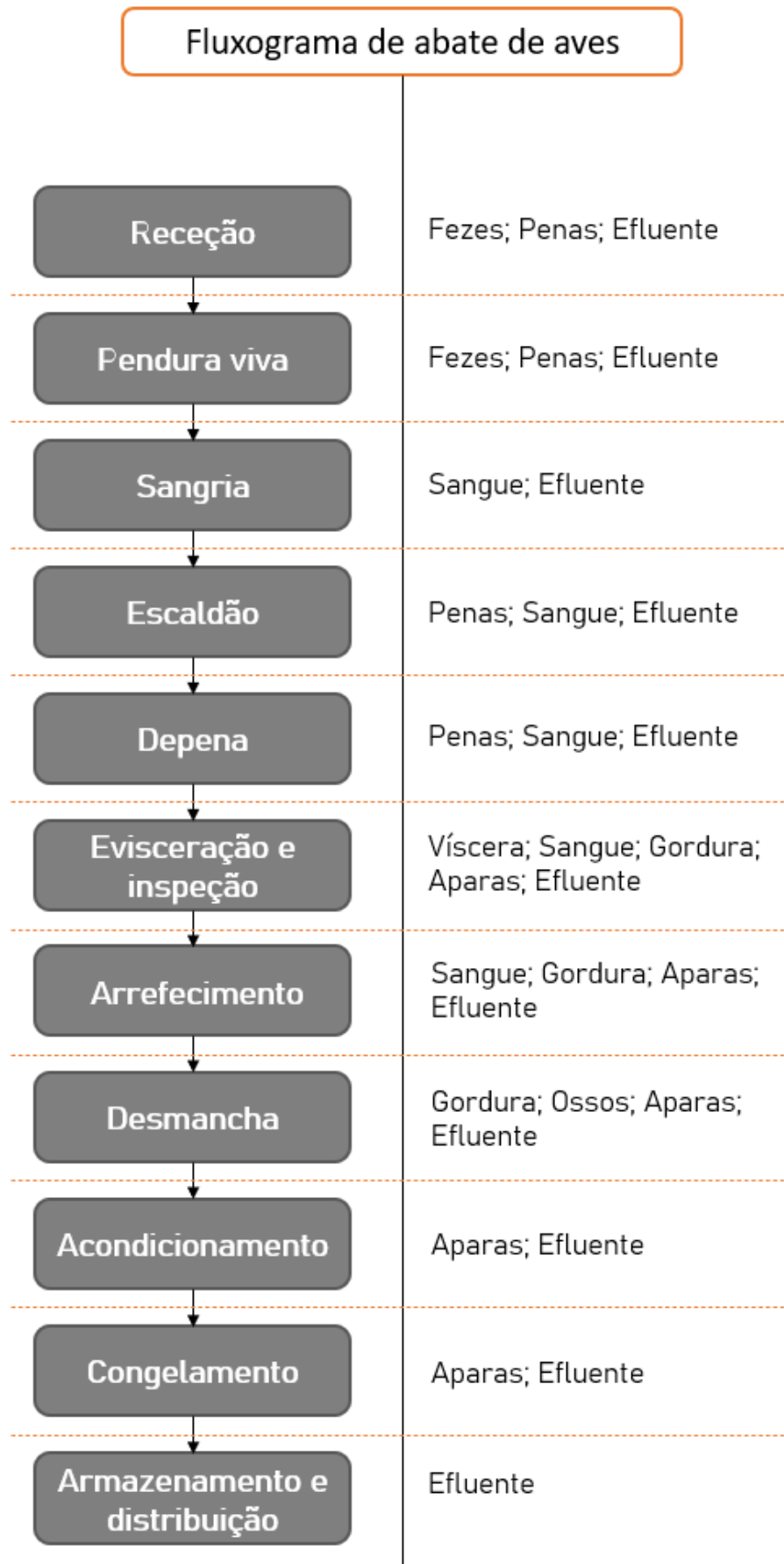
Figura 1.4 - Fluxograma generalizado do processo de abate e transformação de aves com os principais resíduos identificados. Fonte: (Ferreira et al. , 2018)
