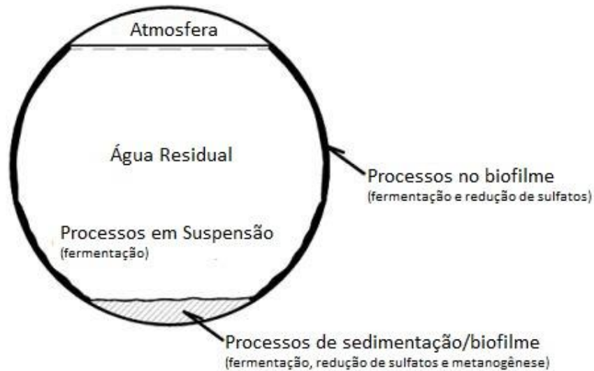
Figura 2.1- Locais onde ocorrem processos de fermentação num coletor Fonte: Stuetz & Franz-Bernd Frechen, 2001
