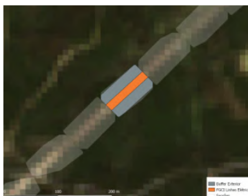
Figura 4.1: FGCI em redor de uma linha elétrica (a laranja) e o buffer adjacente (a cinzento) para efetuar o cálculo de normalização - Retirado de [3]
