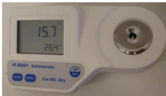
Figura 17: Aparelho para medição do °Brix - Hanna HI 96801
