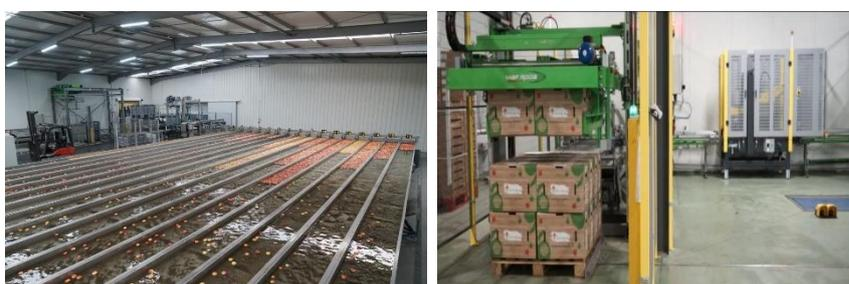
Figura 2: Calibradora de água com 16 canais e Paletizadora automática da linha 3
