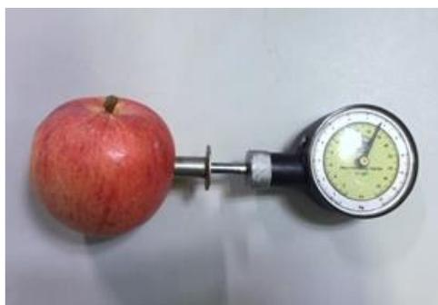
*Figura 16: Medição da dureza da polpa*
