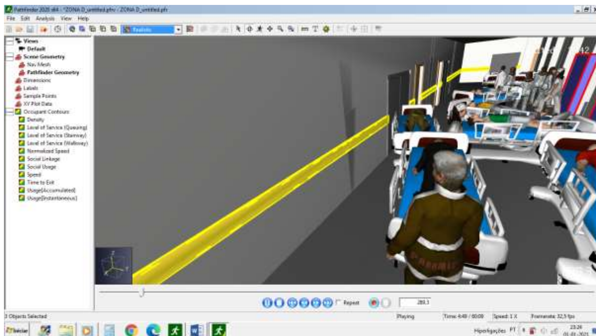
Figura 138 – Hall dos elevadores, como refúgio temporário.
