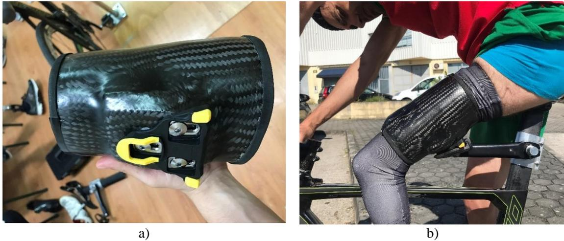
Figura 2.31 a) Copo de interface do dispositivo ao coto do paraciclista em carbono; b) Primeiros testes experimentais do copo em contexto de estrada.
