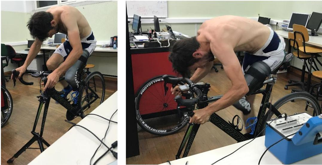
Figura 3.13 Testes dinâmicos com o atleta a pedalar sobre os rolos.
