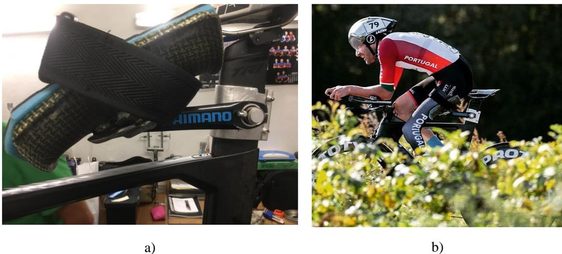
Figura 4.10 Protótipo para bicicleta de contrarrelógio: a) Demonstração do dispositivo montado com o referido entalhe; b) Teste do dispositivo em contexto de prova.
