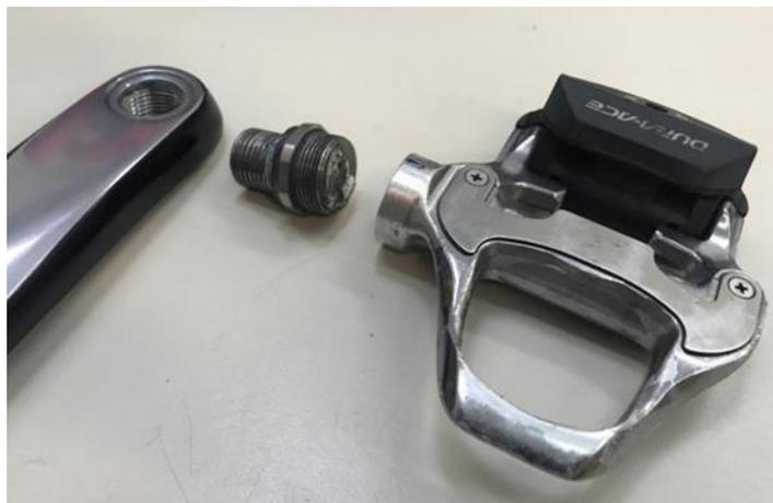
Figura 2.26 Sistema de interface entre o crenco e o pedal.
