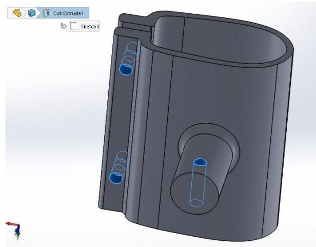
Figura 2.9 Furos realizados na peça de ancoragem.
