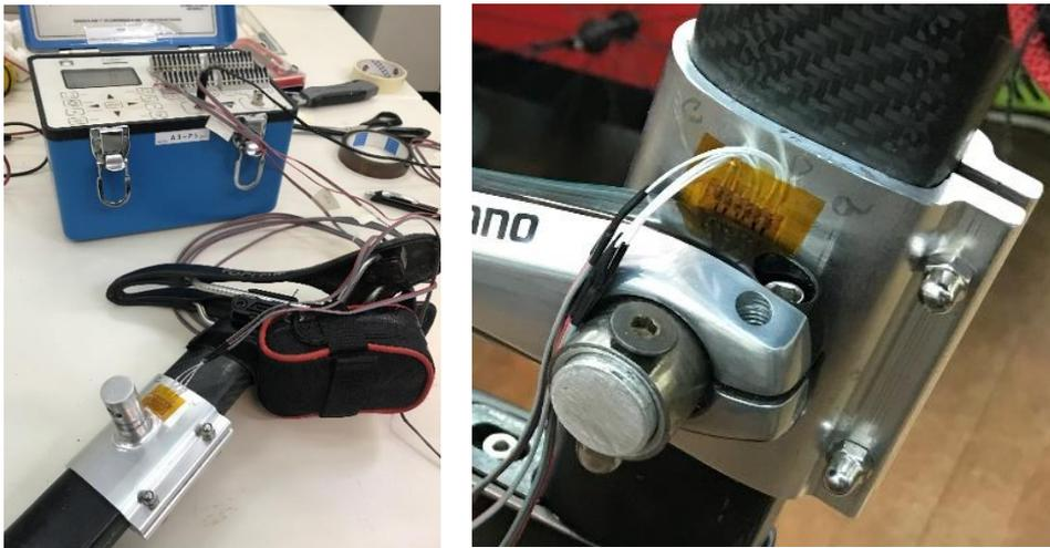
Figura 3.7. Dispositivo de compensação montado e pronto a instrumentar.
