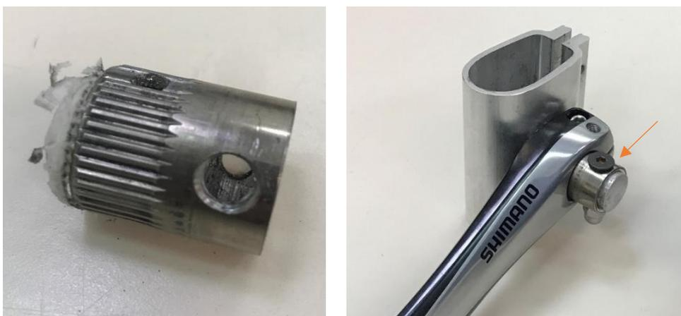
Figura 2.5 Tubo estriado e o mesmo montado no dispositivo.
