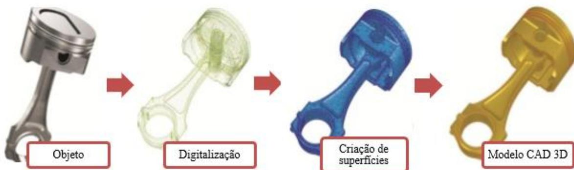
Figura 4.3 Etapas do processo de engenharia inversa (Rana A. ,2016).
