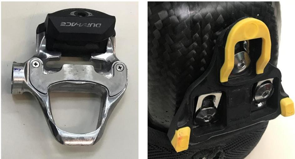
Figura 2.23 Sistema de pedal de encaixe rápido.
