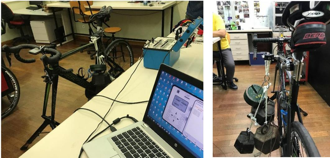
Figura 3.9 Teste estático ao dispositivo de compensação.
