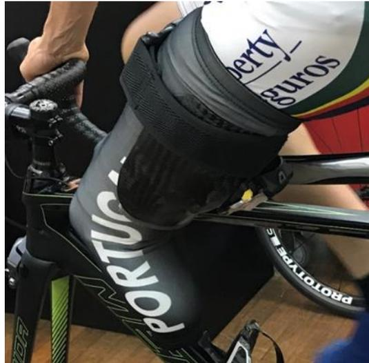
Figura 2.27 Copo de interface entre o dispositivo e o coto do paraciclista.
