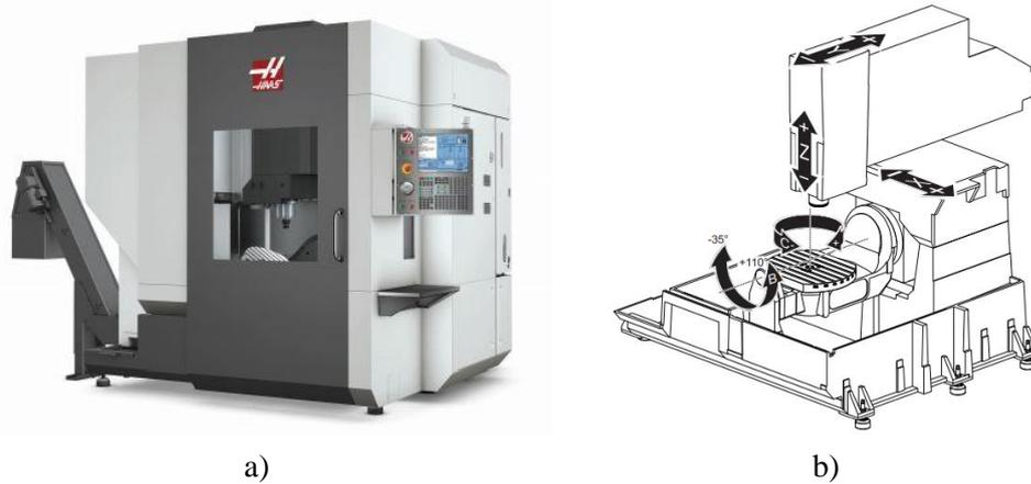
Figura 2.21 CNC HAAS UMC 750SS de 5 eixos: a) Imagem ilustrativa da CNC; b) Eixos de rotação e translação da CNC (Haas Inc., 2015).
