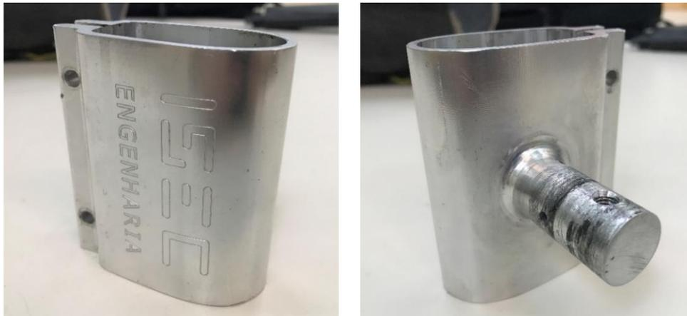
Figura 2.4 Peça de ancoragem do dispositivo ao espigão.
