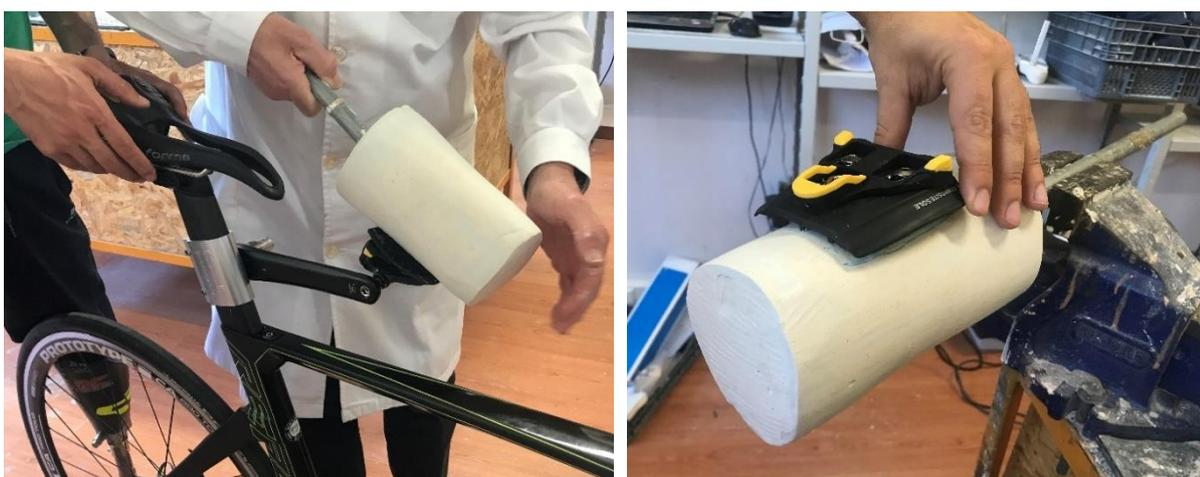
Figura 2.30 Ensaio com contramolde da coxa do atleta para calcular a posição da travessa de encaixe.
