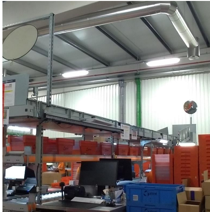
Figura 63: Colocação de espelhos na zona de escoamento de caixas de cartão.
