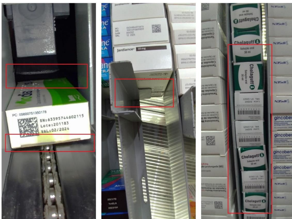
Figura 64: Problemas típicos canais do A-frame (esquerda: escova demasiado baixa e produto colocado incorretamente (aresta sensível para baixo); central: pistola demasiado curta, não dando o suporte necessário; direita: produtos colocados sem critério, sem ter em consideração as arestas sensíveis).
