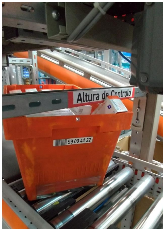
Figura 55: Exemplo de um produto danificado após a receção de mercadoria (altura de controlo).
