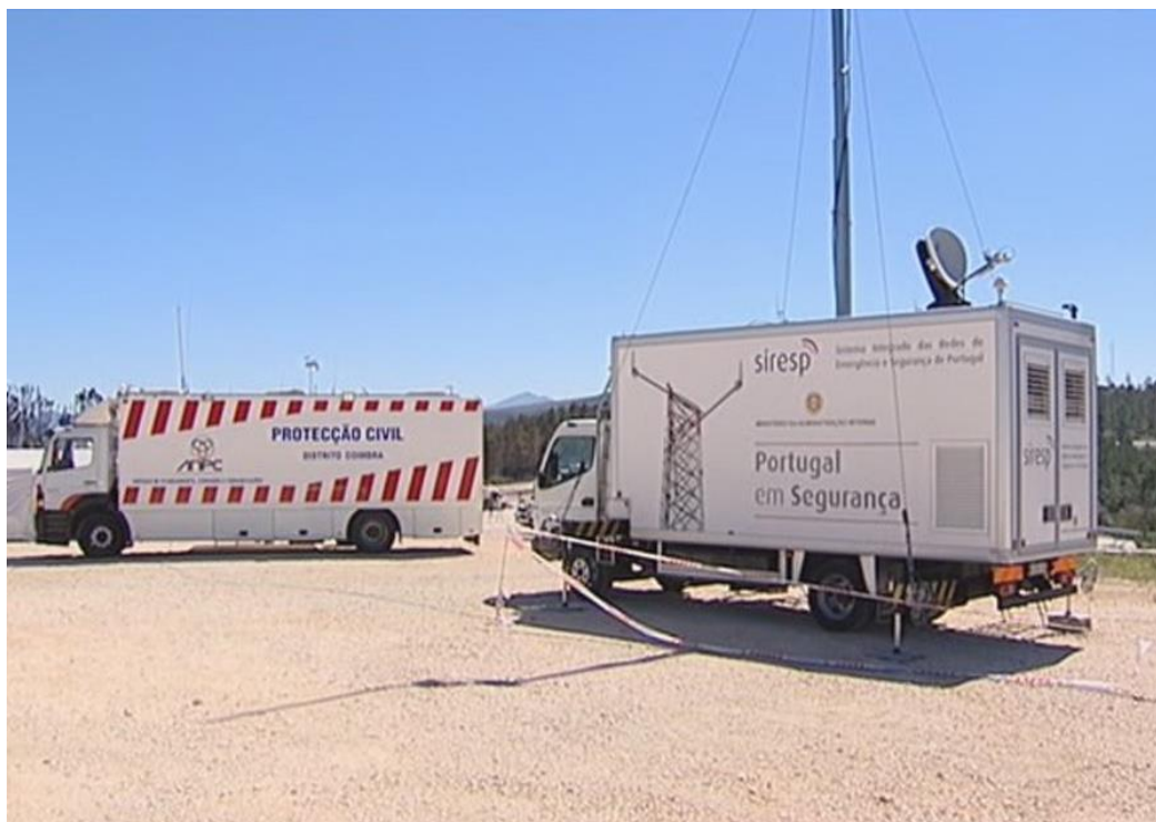
Figura 5: Estação móvel de transmissão do SIRESP (fonte: SIRESP, 2021)
