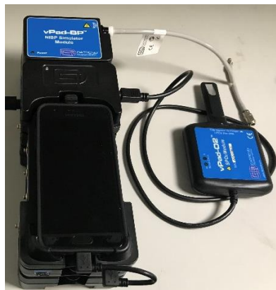
Figura 6.10 – Equipamento de Teste Multiparamétrico Datrend Systems vPad-A
