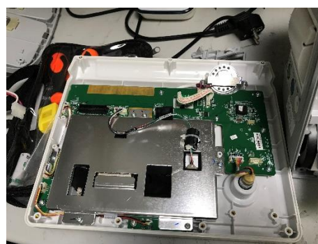
(b) Retirar conector danificado
