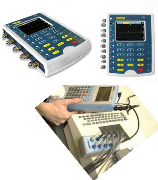
**Figura 14:** Simulador de ECG, imagens obtidas durante os ensaios.
