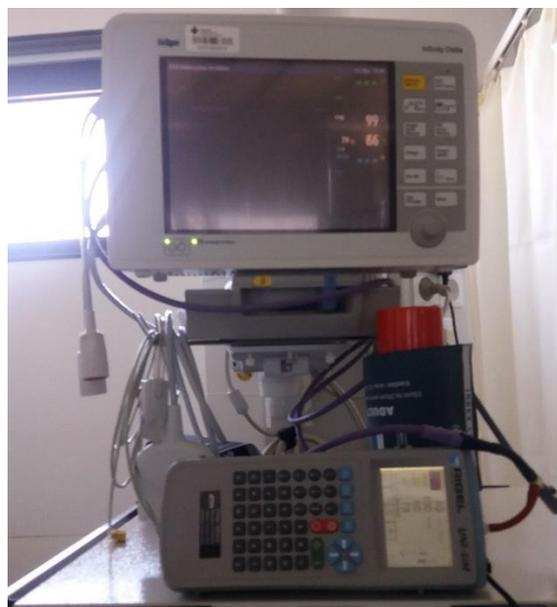
**Figura 29:** Simulador NIBP Rigel conectado a um monitor multiparamétrico, do HVFX, fotografia obtida durante os ensaios
