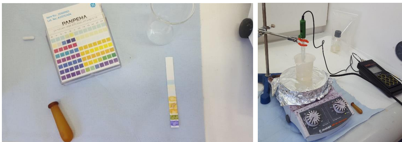
Figura 4.6. Le foto mostrano i 2 metodi adottati per il controllo del pH: a sinistra le cartine tornasole, mentre a destra il pH-metro elettronico.
