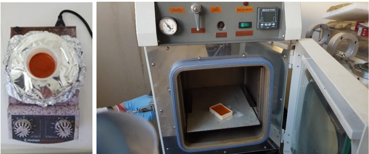
Figura 4.7. Le foto mostrano il processo di stirring a sinistra e drying a destra.
