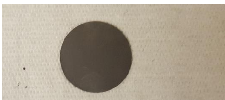
Figura 1.10. Rappresentazione di un prototipo di bersaglio diretto del Progetto SPES
