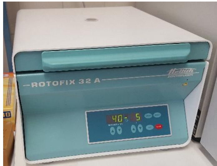
Figura 5.3. Foto raffigurante la centrifuga ROTOFIX 32 utilizzata per sedimentare l'Anatasio.
