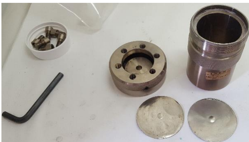
Figura 5.2. Foto raffigurante l'autoclave in acciaio utilizzata per poter effettuare il trattamento idrotermale a 200\text{ [}^\circ\text{C]} e 15\text{ bar} di pressione.
