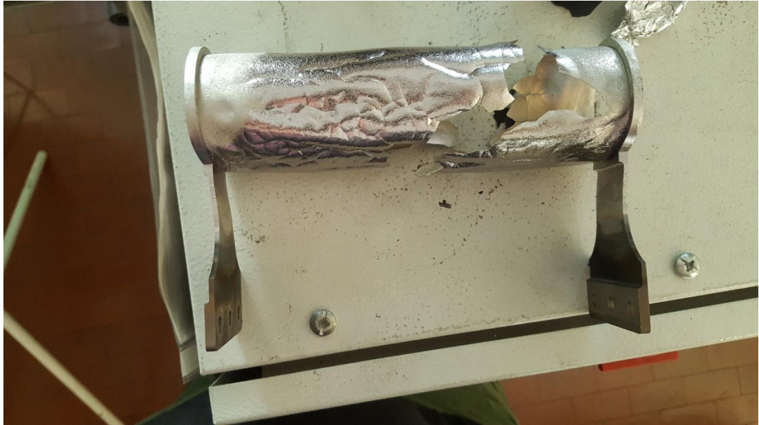
Figura 3.5. Foto raffigurante il riscaldatore del forno ad alto vuoto dopo rottura.
