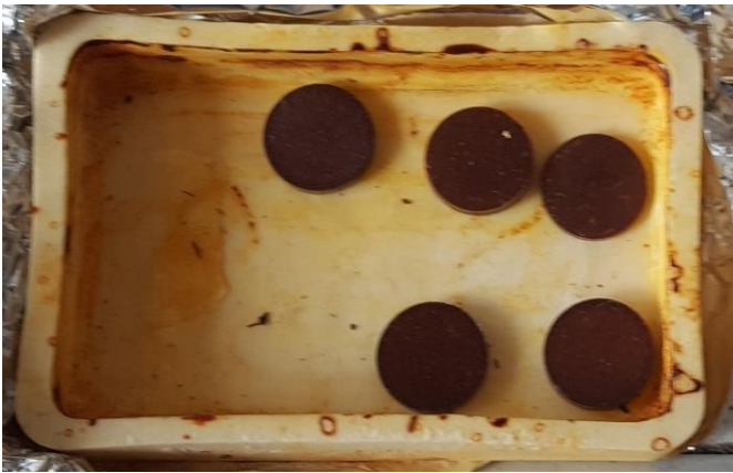
Figura 4.10. La foto a sinistra mostra il crogiolo contenente i verdi, prima del trattamento termico; nella foto di destra sono visibili 5 campioni che hanno subito il trattamento termico.
