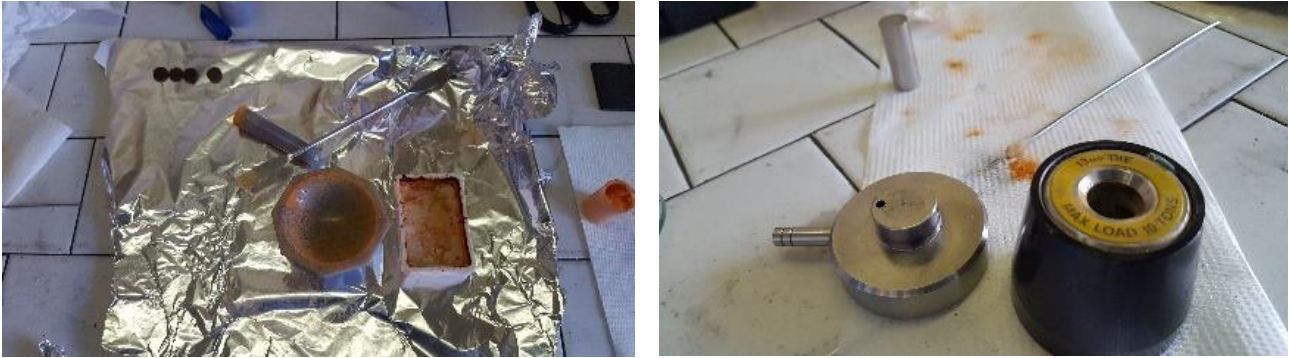
Figura 4.8. La foto a sinistra mostra il mortaio e pestello con cui è stata eseguita la macinazione, a destra è mostrato lo stampo da 13 [mm] utilizzato.
