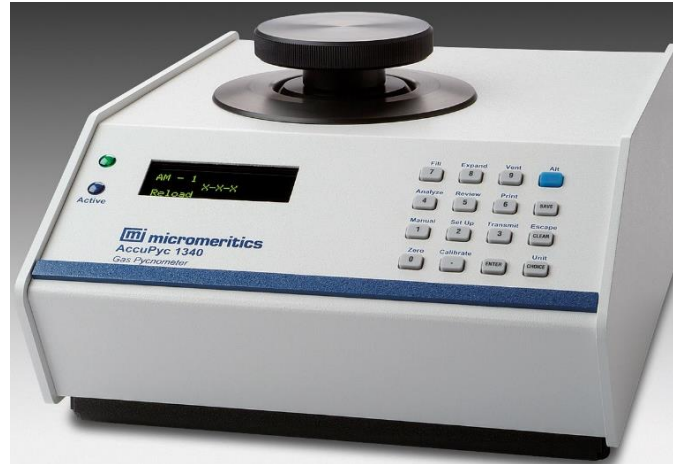
Figura 3.20. Immagine rappresentante il Picnometro ad elio “Micromeritics AccuPyc 1340” utilizzato.
