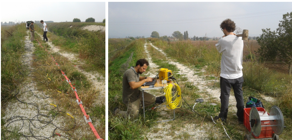
(a) Land streamer: geofoni posizionati sulle piastre, legate tra loro tramite la fascia. (b) Sismografo Geode, computer portatile e mazza.
