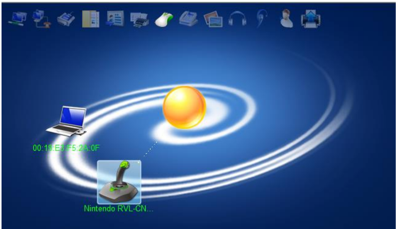
Figura 2.4 Interfaccia del software Blue Soleil. Da notare il riconoscimento e l'associazione della WBB (Nintendo RVL-WBC-01)
