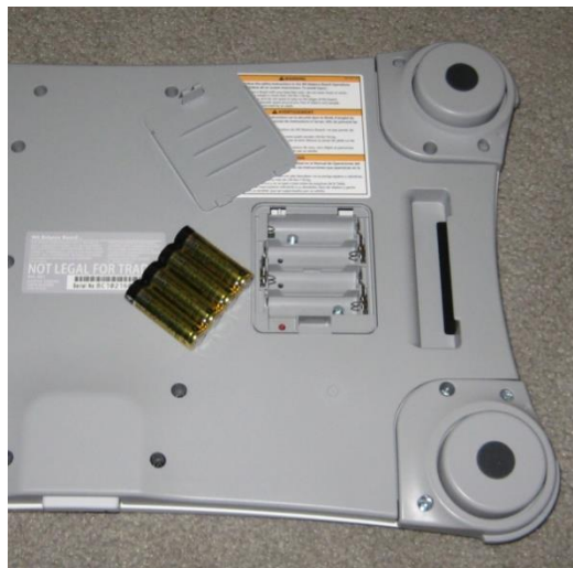
Figura 2.3 Dettaglio della WBB che mostra l'alloggiamento delle batterie ed il pulsante "SYNC"
