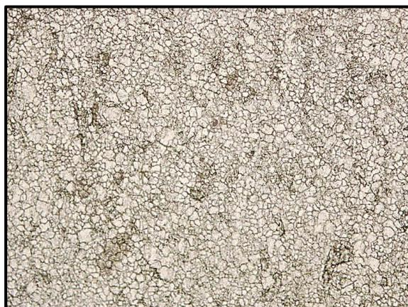
Figura 26 Substrato di acciaio 316. Campo chiaro, 20x.
