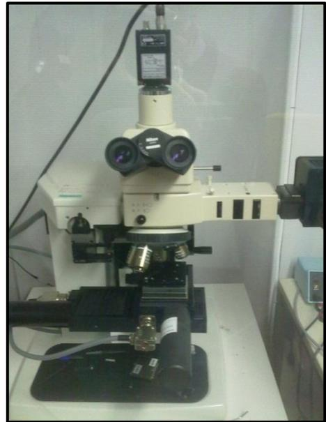
Figura 67 Nanoindentatore utilizzato
