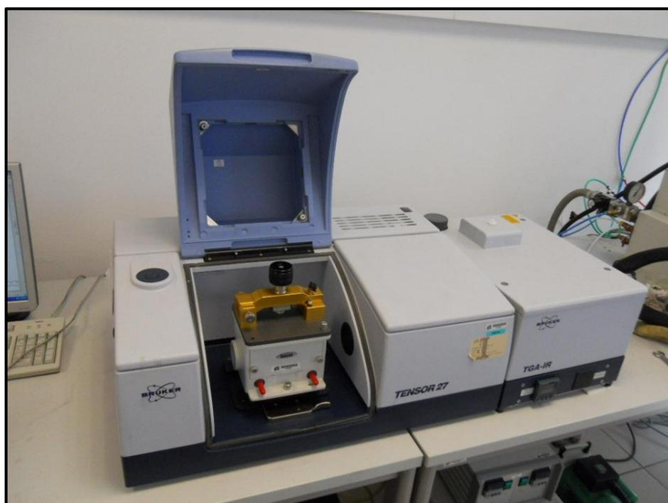
Figura 45 Spettroscopio a raggi infrarossi utilizzato
