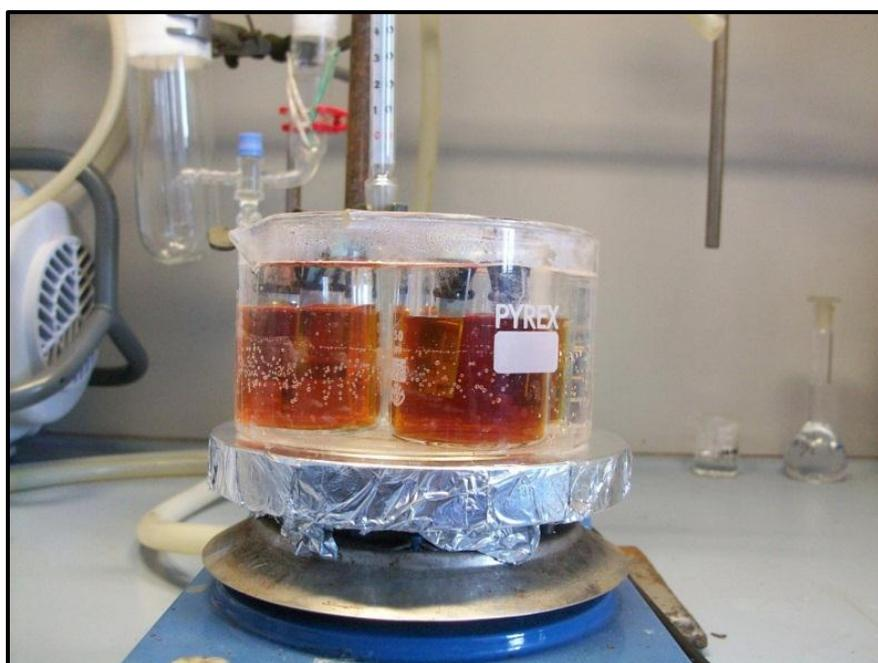
Figura 27 Apparato strumentale per test qualitativi di corrosione
