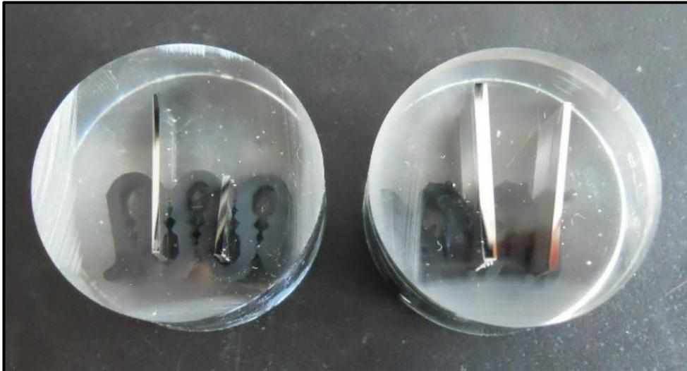
Figura 49 Provini inglobati in resina, tagliati in sezione e lucidati a specchio
