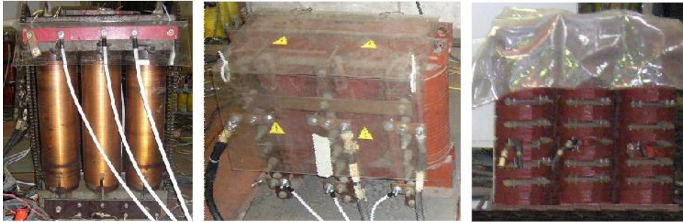
Figura 5.7: Catena di livellamento della tensione: variac (a sinistra), trasf. multipresa (al centro), trasf. abbassatore (a destra).
