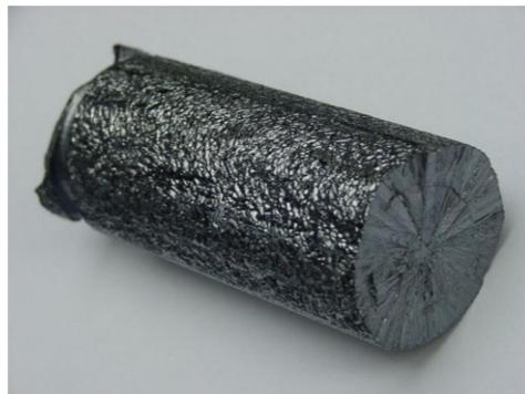
*Figura 2.23: Lingotto in silicio policristallino per la produzione di silicio monocristallino attraverso il metodo Czochralski (lunghezza 10 cm, diametro 4 cm)*
