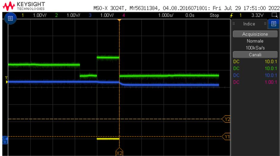
Figura 5.8: Andamento della tensione ai capi del modulo in silicio amorfo in funzione del tempo (curva in verde) e della tensione ai capi del carico in funzione del tempo (curva in blu)
