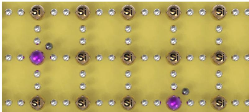
*Figura 2.3: Reticolo cristallino del silicio drogato di tipo n*
