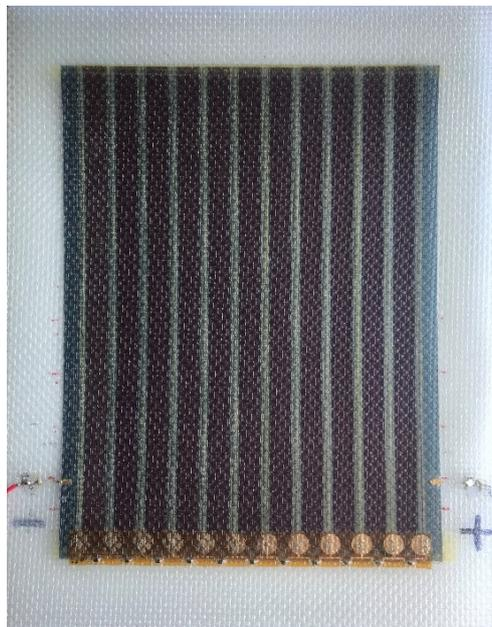
*Figura 2.33: Modulo commerciale DSSC flessibile G24i di Gcell*
