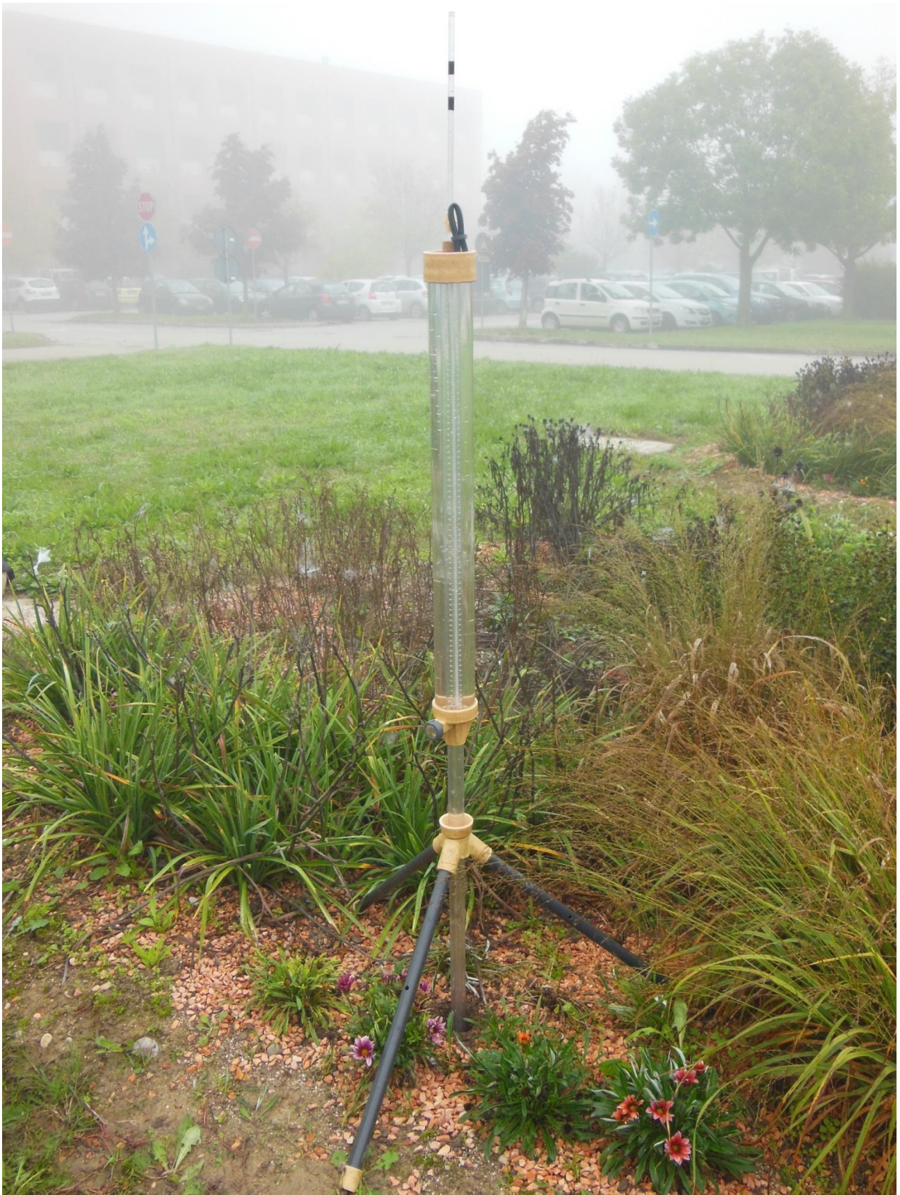
Figura 3. 14: Permeametro di Guelph installato nel rain garden di Agripolis
