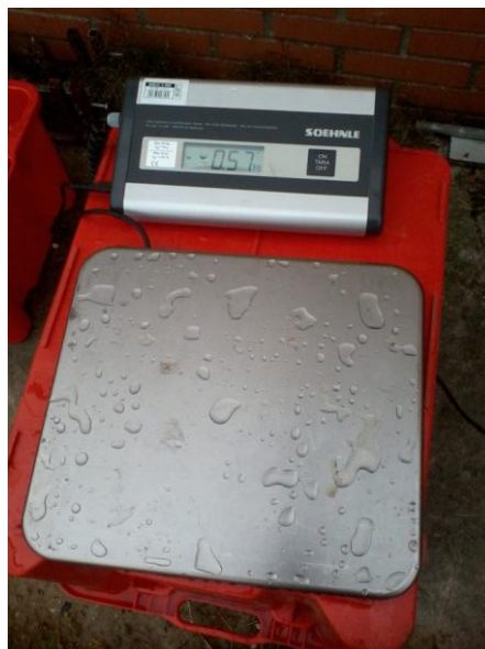
Figura 3. 438: Bilancia elettronica utilizzata durante le prove di taratura dello stramazzo
