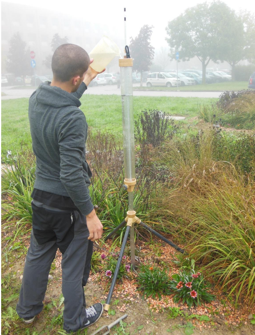
Figura 3. 24: Fase di riempimento del serbatoio del permeametro di Guelph
